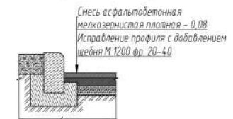
Ремонт асфальтобетонного покрытия
